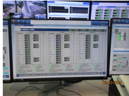
รูปที่ 3-2 ระบบเตือน (Alarm) เพื่อควบคุมค่าการระบาย NO x
